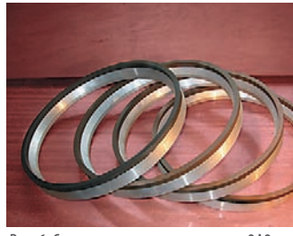
Рис. 6. Специальные алмазные круги 2A2 для обработки граней и радиусов твёрдосплавных пластин
