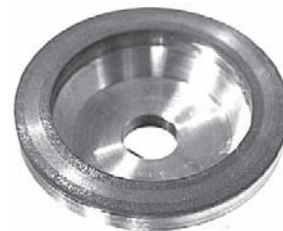
Рис. 4. Круг формы 12A2 со слоистой рабочей поверхностью
