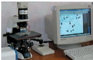
Рис. 13. Прибор Dialnspect.OSM и окно программы обработки данных по зёрнам порошков
