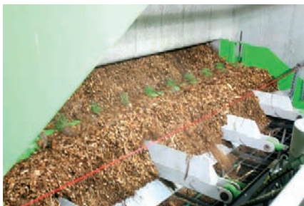
↑ Рис. 1. Фрагмент автоматического склада топлива. Виден горизонтальный рыхлитель топлива
