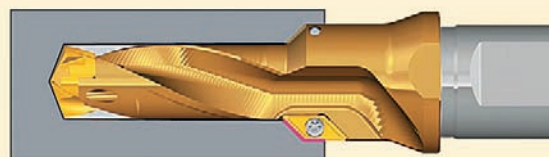
↑ Рис. 7. Схема сверления и дополнительного растачивания за один проход ступенчатого отверстия сверлом DRILLRUSH с боковыми пластинами
