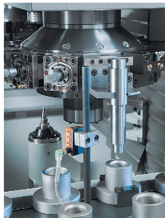
VTC 100-4 — установка готового вала на конвейер при помощи грейфера, размещенного на револьвере
