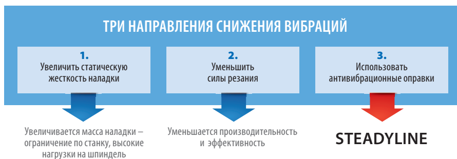
↑ Рис. 1. Способы уменьшения вибраций при резании
