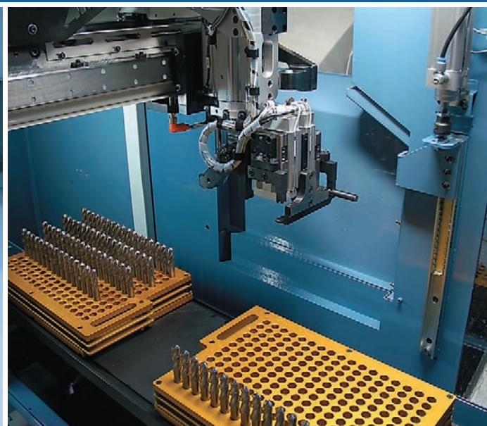
↑ Автоматический портальный манипулятор для загрузки деталей
