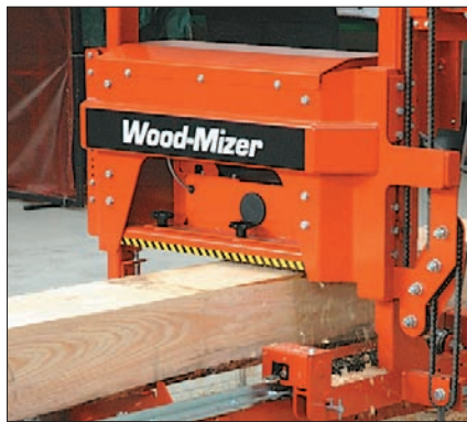
↑ Строгальный механизм для бревен и бруса
