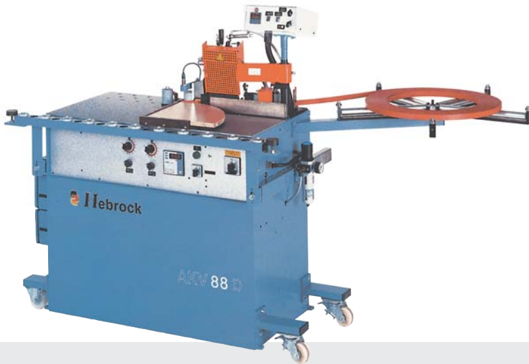
Рис. 3. Кромкооблицовочный станок модели AKV 88D
