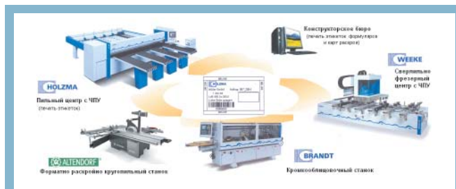
Рис. 2. Области автоматизации производственного процесса с использованием системы Cut-Rite
