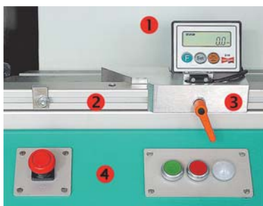
Рис. 6. Цифровой указатель длины детали: 1. Цифровой указатель длины; 2. Рабочий стол; 3. Торцовочный упор; 4. Панель управления станка
