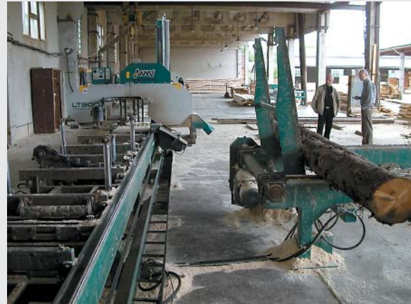
Для этого станка LT300 фирма Wood-Mizer спроектировала нестандартную загрузку бревна — с другой стороны станины
