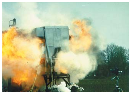
Рис. 4. Тестовый взрыв на образце фильтра Moldow
