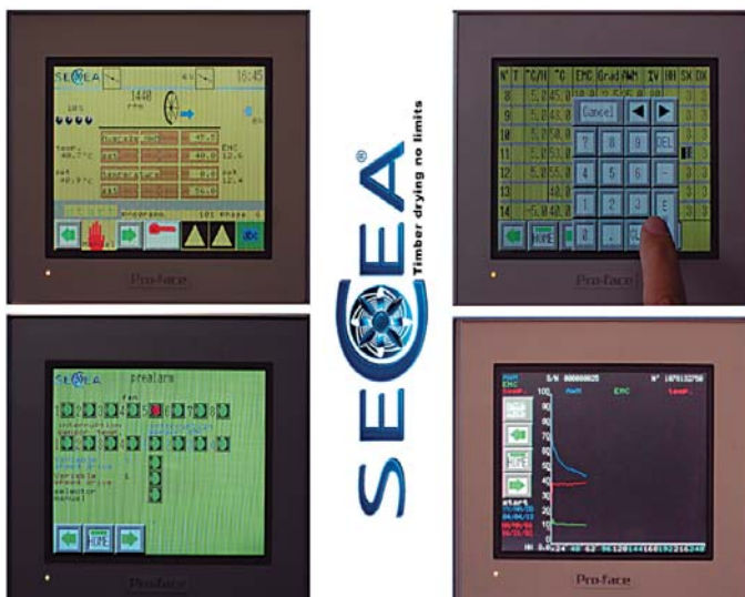
Рис. 2. Меню контроля параметров установки и данных цикла сушки
