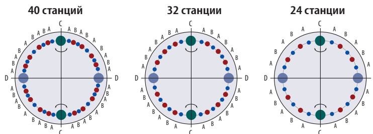
Схема расположения инструментальных станций в револьверном барабане
