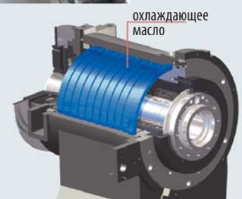
Рис. 5. Электродвигатель, встроенный в шпиндельную бабку
