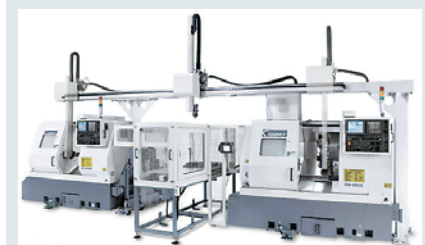
Рис. 7. Роботизированные погрузочно-разгрузочные системы позволяют объединить несколько станков в комплекс для механической обработки деталей
