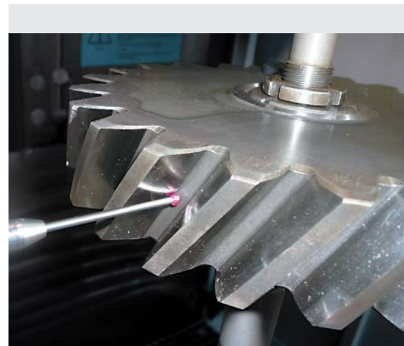
Рис. 5. Измерительное устройство на станках RZ 630, RZ 800 и RZ 1000
