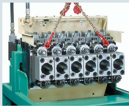
Рис. 4. Система быстрой перенастройки Variblock с набором инструментов для штампа и матрицы
