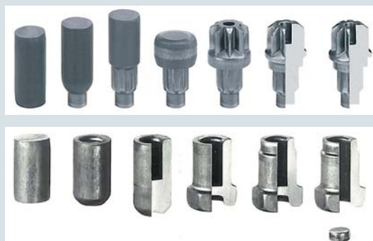
Рис. 2. Последовательность операций изготовления штамповкой ведущей шестерни на прессе COLDMATIC AKP4-6 S
