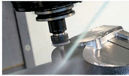
Шпиндель 12 000 об/мин с устройством векторного привода
