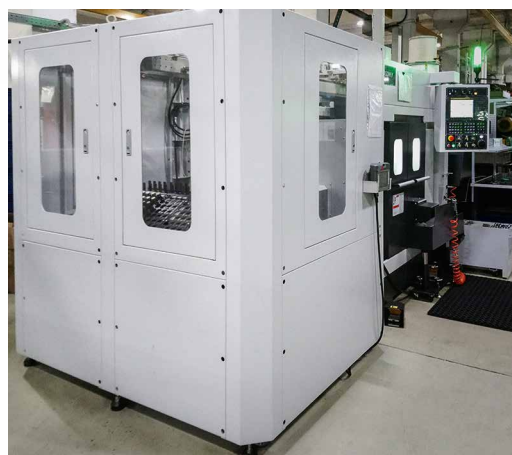
↻ Накопитель заготовок/деталей токарного комплекса
