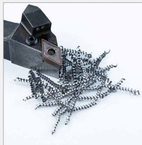
↻ Влияние давления СОЖ на размер и форму стружки
