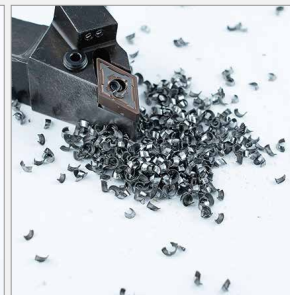
↻ Влияние давления СОЖ на размер и форму стружки
