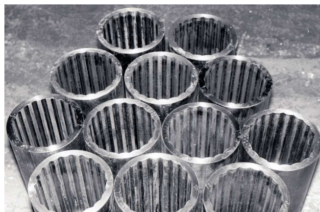
Рис. 5. Збірний деформуючий елемент протяжки: 1 – сталевий корпус; 2 – твердосплавні вставки
