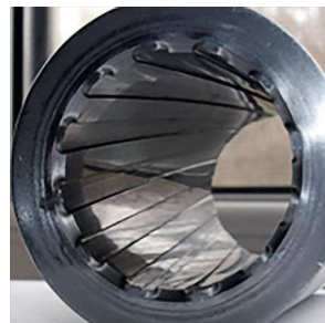
Рис. 4. Внутрішня поверхня заготовки після протягування
