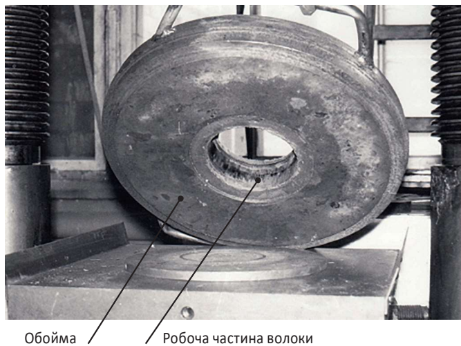
❖ Рис. 8. Збірна волока для редукування заготовки \varnothing 168 \times 16
