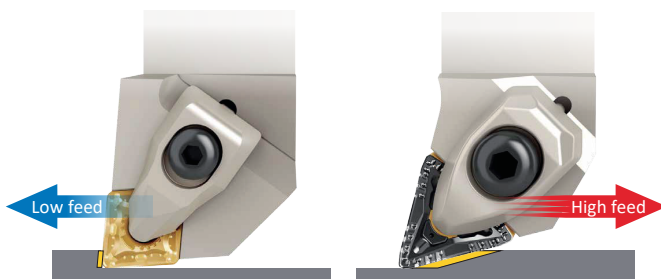
Рис. 3. Товщина стружки залежно від кута у плані та подачі
