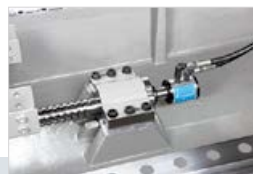
Комплекс безперервного охолодження вузлів верстата
