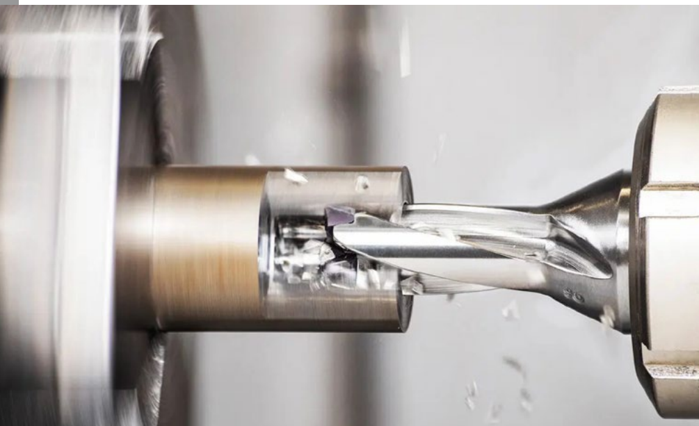
Рис. 1. Триканавкова головка QUICK-3-CHAM для високопродуктивної обробки матеріалів ISO M
