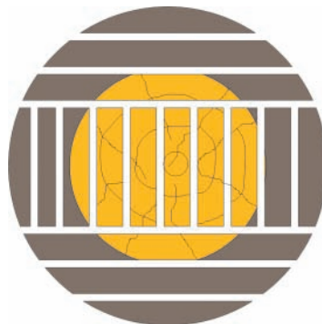
Рис. 1. Схема раскроя бревна при рамной распиловке
