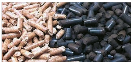
↑ Пеллеты из различного биосырья, обычные и торрефицированные разной формы и размера
