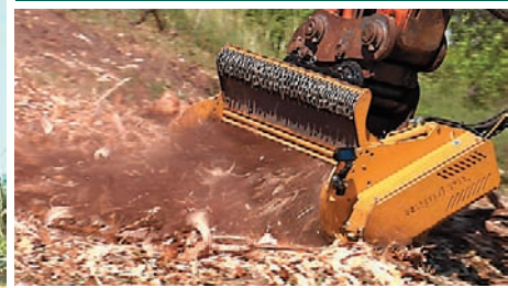
↓ Фото 4. Мульчер BMS-F размалывает древесину и ветки диаметром до 20 см
