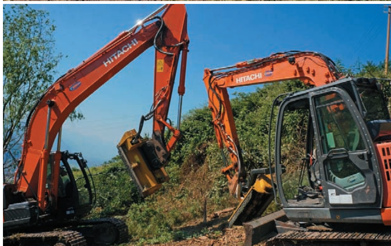
↑ Фото 1. Мульчер SEPPi на экскаваторе HITACHI над Больцано
