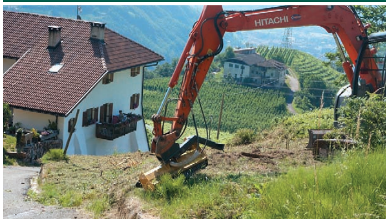
↑ Фото 2. Измельчитель H3 удаляет высокую траву и густые кустарники
